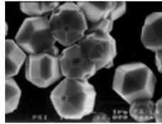
Um das Startkristall herum bilden sich weitere Diamantkristalle. Die Dauer des Wachstums ist abhängig von der gewünschten Grösse des Diamanten.
